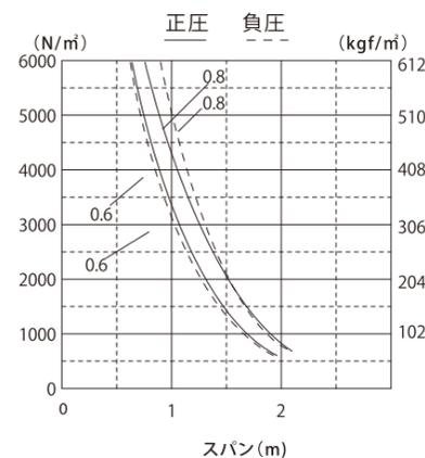
〔屋根30分耐火認定〕無機質高充填フォームプラスチック及びガラス繊維系無機質断熱材 (FRP030RF-1867:母屋ピッチ2m以下)
