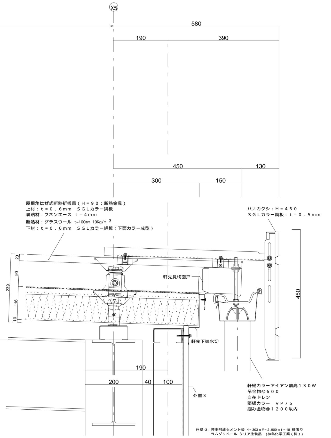
屋根角はゼ式断熱折板葺(H=90:断熱金具)
