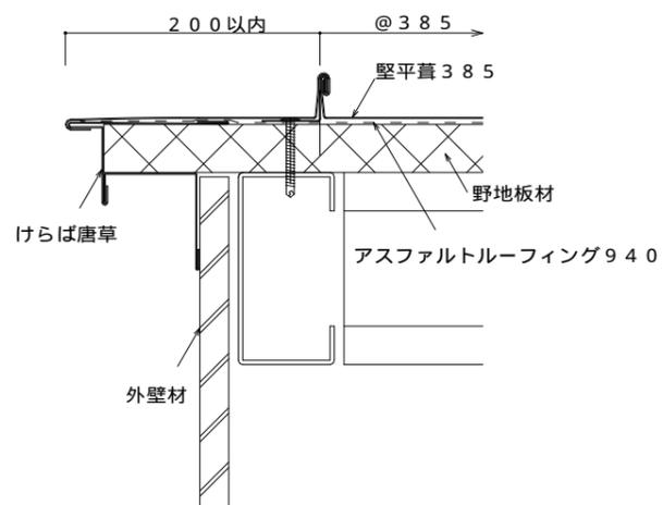
堅平葺 385 壁取合部 (流れ) 納め図
