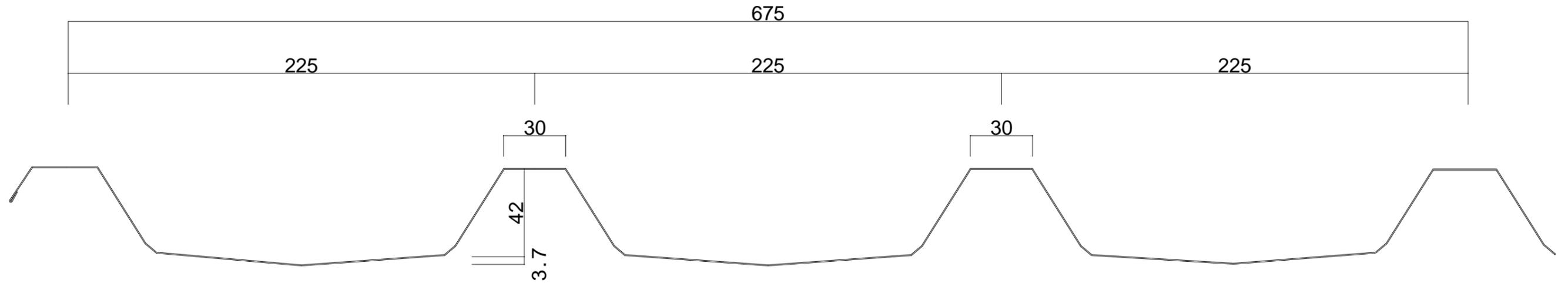
ルーフワイドカバールーフ 改修工法 (直接固定工法) 断面図 ノンアスベスト製品への改修用製品
